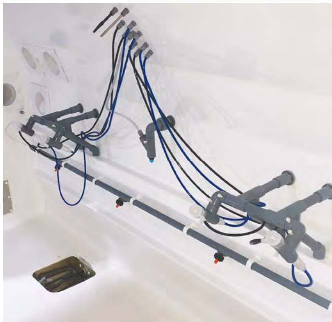
2600L Atmosfär 高级试验箱上的双雾化器系统示例
